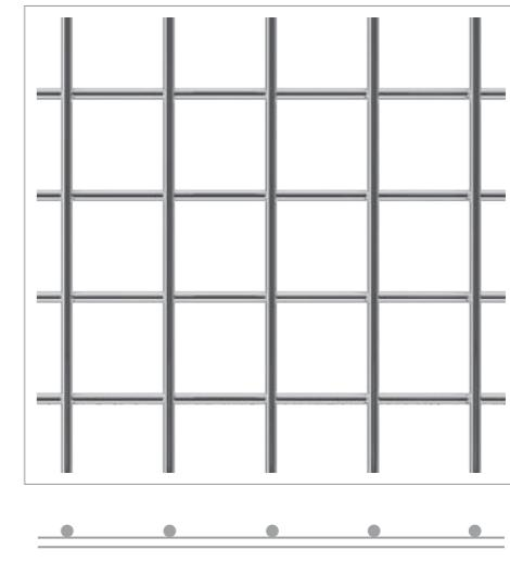
Le reti elettrosaldate sono formate da fili dritti ortogonali in trama e in ordito, sovrapposte e saldate tramite elettropuntatura.
