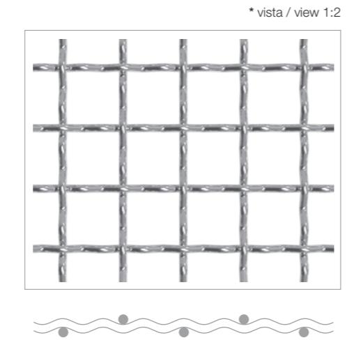
Le reti ondulate sono ottenute intrecciando fili trafilati che vengono preventivamente ondulati da ingranaggi che consentono precise curvature del filo.
